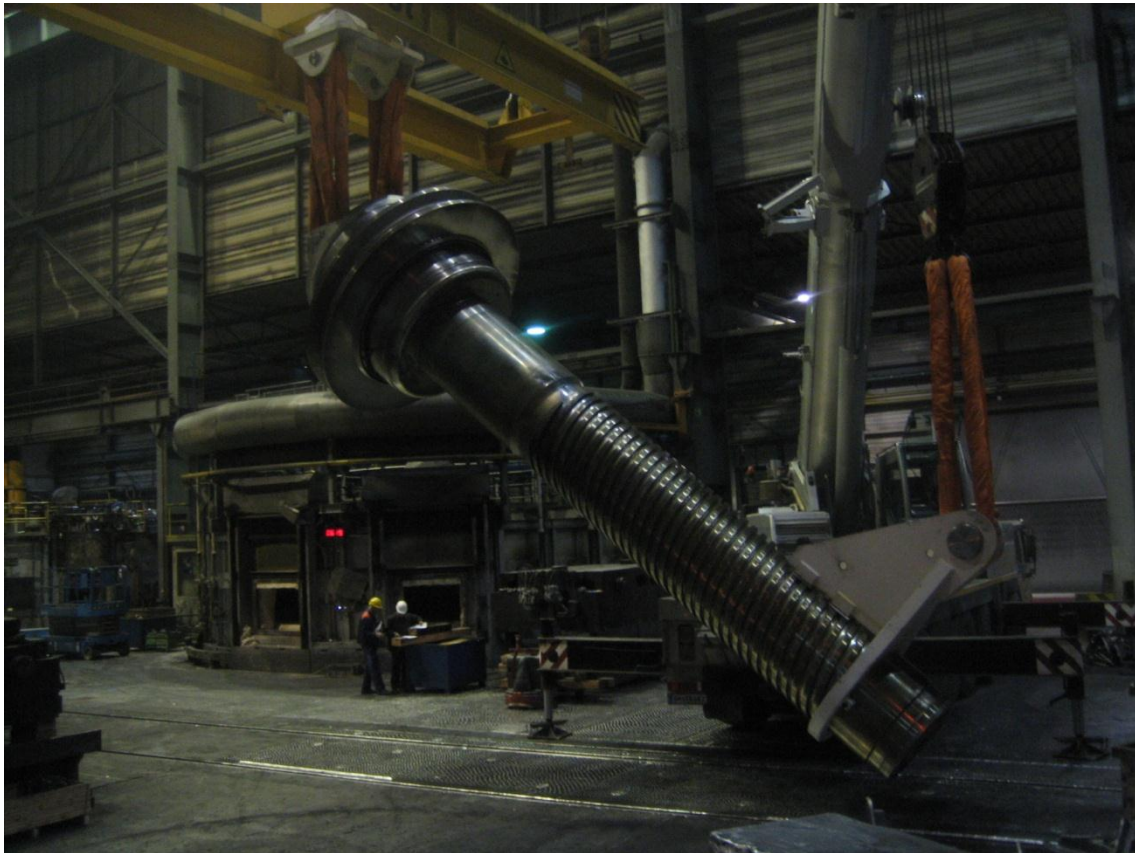
Umlegevorgänge mit Hilfe eines Autokranes und des Hauptkrans.
