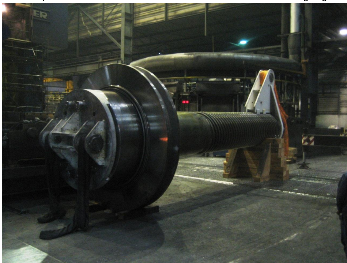
Die Spindel ist in horizontaler Position und wird auf den Hilfsbock gelegt.
