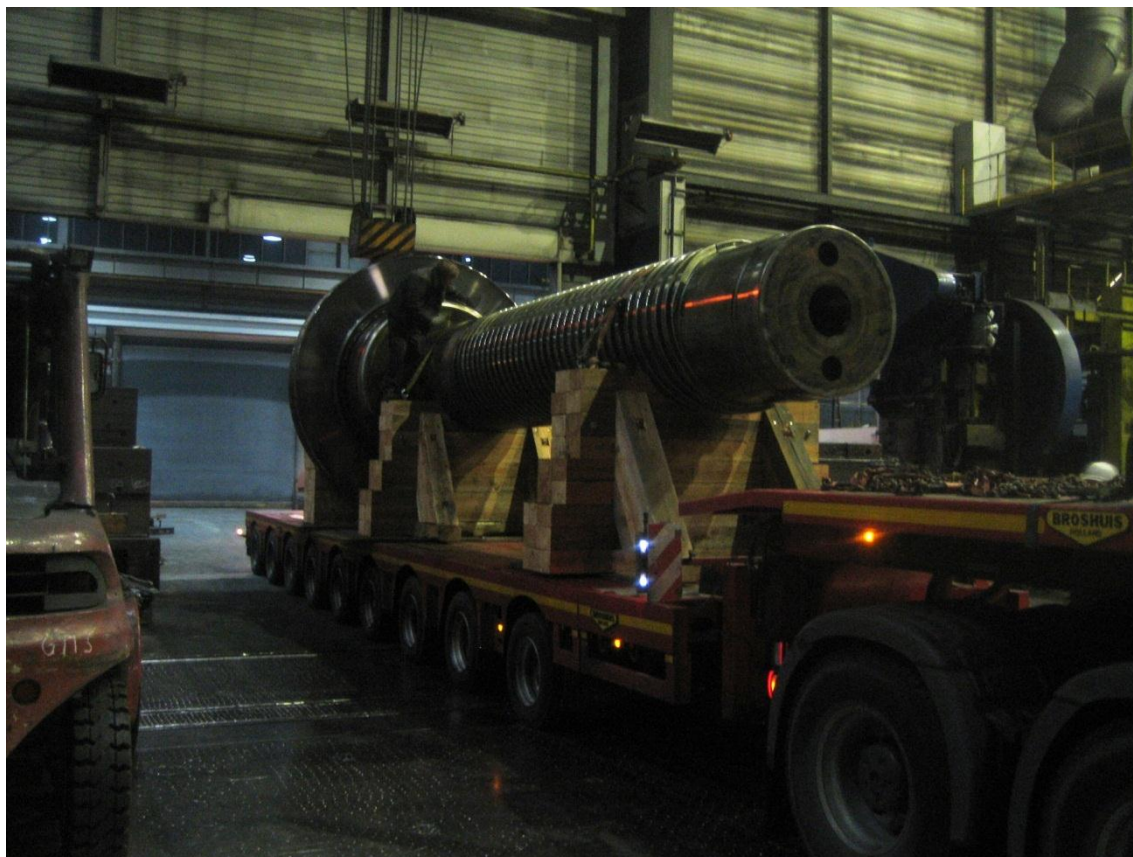
Auflegen der Spindel auf den Hilfsbock und Abtransport mittels Tieflader
